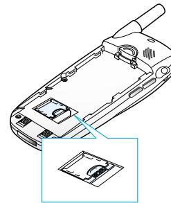
6. Вложите батарею в телефон, и продвигните ее в сторону фиксатора до установки на место. Перед включением телефона проверьте правильность установки батареи.
