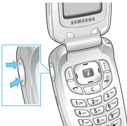
В режиме ожидания при открытой откидной панели эти клавиши позволяют регулировать громкость тональных сигналов клавиатуры.
