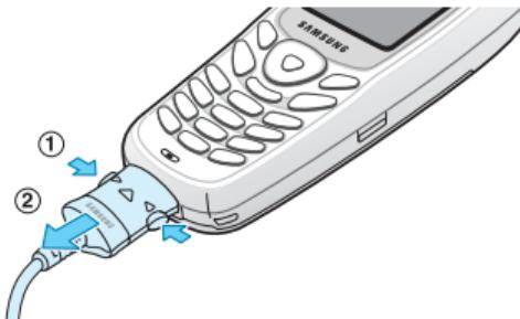
**Примечание.** Если требуется снять аккумулятор с телефона во время зарядки, необходимо предварительно отключить зарядное устройство; в противном случае возможно повреждение телефона.
